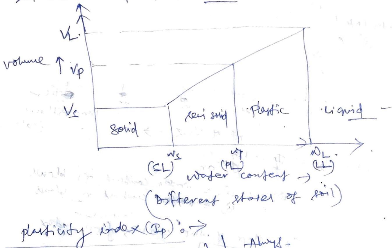
$$I_p = w_L - w_p \quad | \quad \text{Always} \quad I_p > 0.$$
